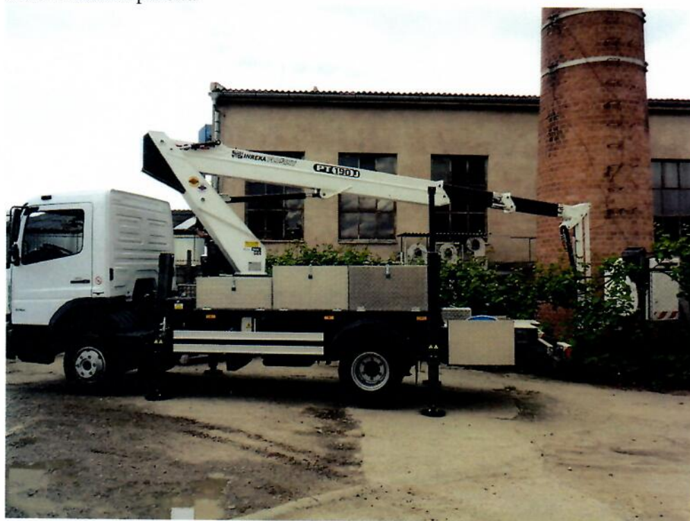
Obr. možnost spuštění pracovního koše k zemi včetně možnosti spuštění za překážku díky koncovému rameni JIB
