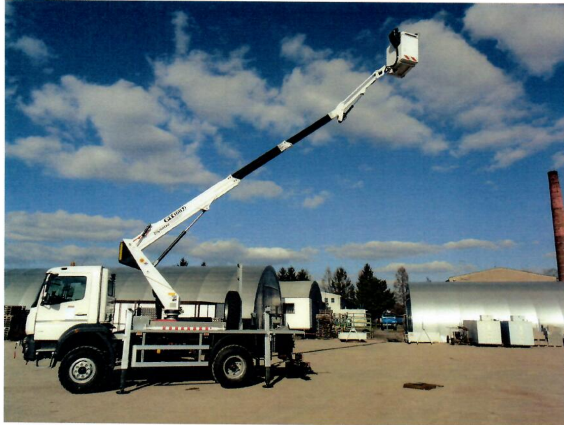
Obr. Při výsuvu je vše vedeno uvnitř ramen - hadice, kabely, řetězy, výsuvný válec – chráněno proti opotřebení a poškození.
