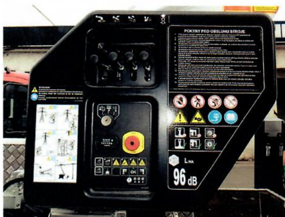
Obr. ovládání na spodním a horním stanovišti
